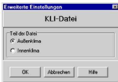
\*.KLI-Dateien enthalten Daten zum **Außenklima** (Regen, Strahlung, Lufttemperatur, relative Feuchte) und zum **Innenklima** (Lufttemperatur, relative Feuchte). Wenn Sie eine \*.KLI-Datei der linken Seite des Bauteils zuweisen, liest WUFI üblicherweise die Außenklimadaten aus der Datei; wenn Sie eine \*.KLI-Datei der rechten Seite zuweisen, liest WUFI die Innenklimadaten. In diesem Dialog können Sie eine davon abweichende Wahl treffen. Regen und Strahlung werden dann ignoriert.
